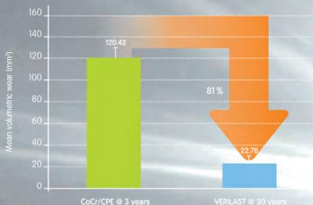
Vergleich des durchschnittlichen volumetrischen Abriebs von CoCr/ konventionellem PE nach simulierten 3 Jahren im Vgl. zu VERILAST® nach simulierten 30 Jahren.\*
